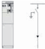
C – Toprak bıçaklı yük ayırıcı ünitesi 630A nominal akım, 25kA 3(s) kısa devre dayanımı
